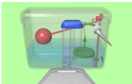
Illustration 2: visualisation du mécanisme d'une chasse d'eau pour être moins sceptique en cas de panne (source[10])
