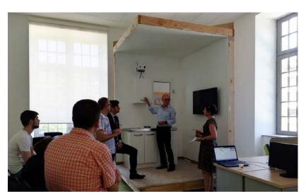
Plateau modulable à la Maison des sciences de l'Homme, avec une installation prototype. Le plancher est équipé de 16 capteurs par m², qui permettront notamment d'étudier les déplacements des occupants.
